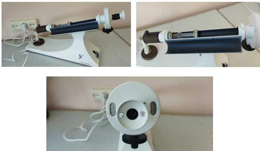
Рис. 44.2. Поляриметр ручной Polar-2010 LED JP Selecta S.A. (Испания): 1 – станина; 2 – кнопка включения питания; 3 – поляриметрическая трубка с анализируемым раствором; 4 – крышка кожуха поляриметра; 5 – поляризатор; 6 – анализатор; 7 – поворотная ручка анализатора; 8 – окуляр; 9 – верньер; 10 – увеличительное стекло верньера.
